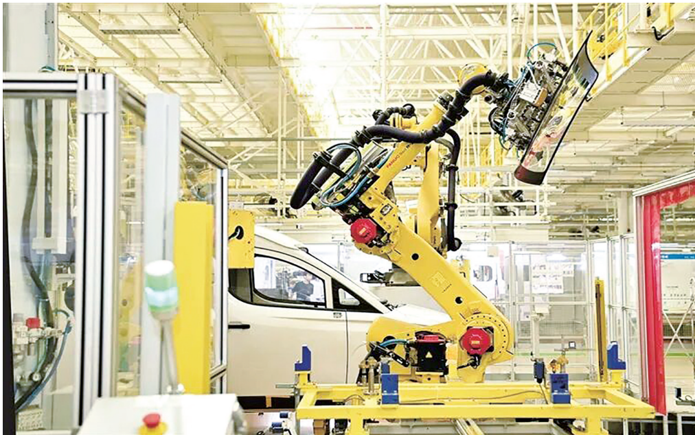
广西汽车集团新能源汽车基地,机器人在安装汽车玻璃。
